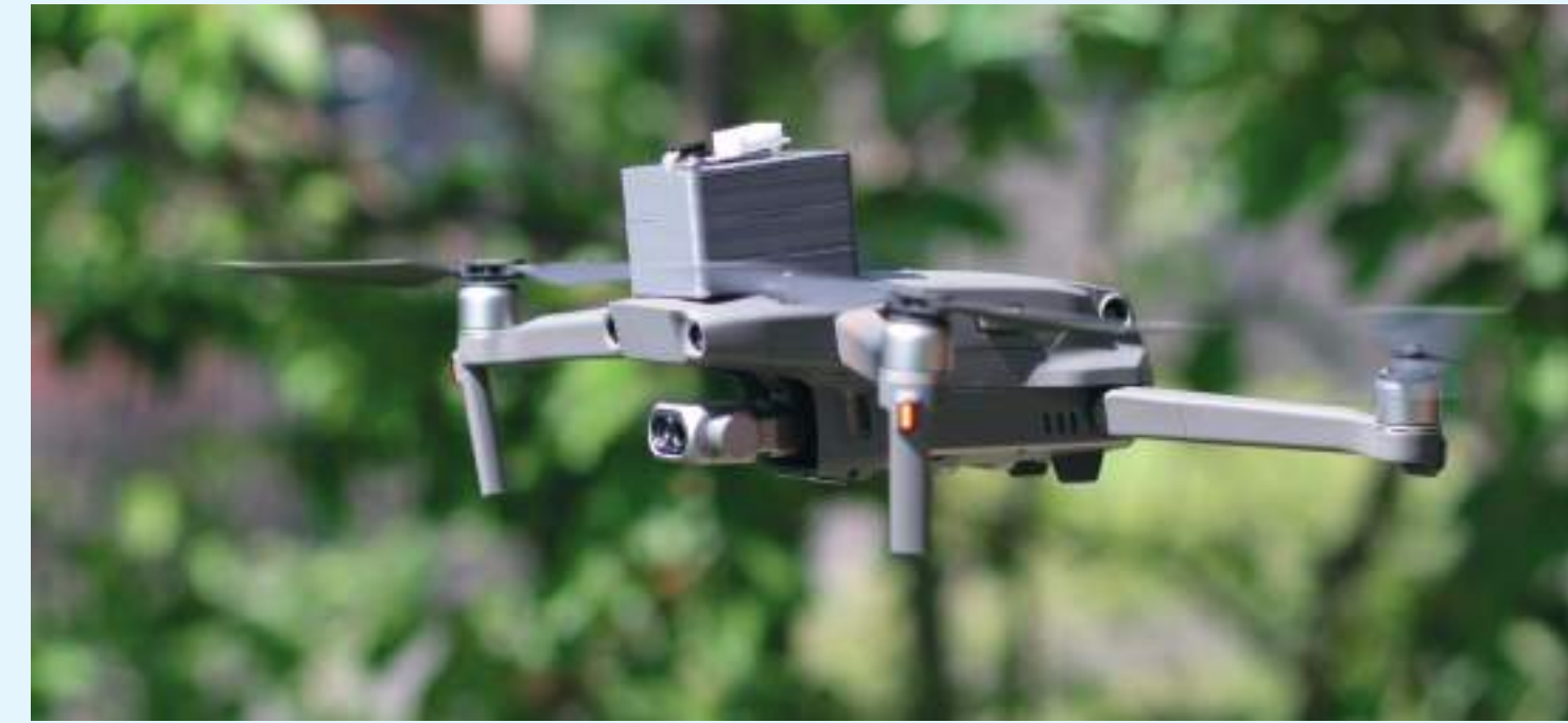
ការប្រើប្រាស់នៃ UAV មួយសម្រាប់ការអនុវត្តឧបករណ៍វាស់ពីចម្ងាយ៖ សហគ្រាស DJI Mavic 2 ជាមួយ កាមេរ៉ាកម្ដៅ (រូបភាពទី១៧)
